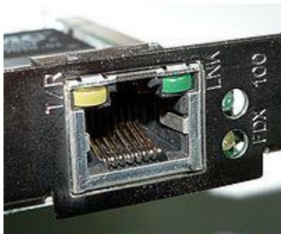
Figure 1 : port RJ45 femelle sur une carte réseau de PC
